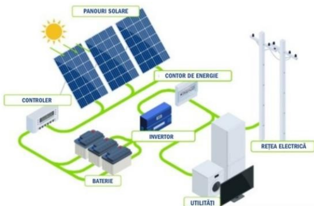
Fig. 2.1 Sistem fotovoltaic cu stocare integrată
